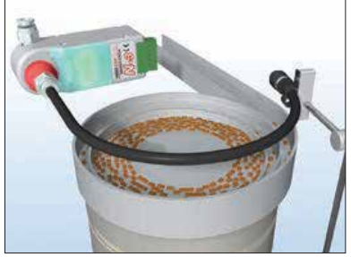
Máy cấp chi tiết (đầu nối + ống thổi)
